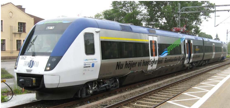
Figur 4.1 I forsknings- och utvecklingsprogrammet Gröna Tåget utfördes flera provserier 2006–08 för att undersöka möjligheterna att öka hastigheten. Ett stort antal prov utfördes i hastighetsområdet 250–303 km/h på olika typer av spår, alla avsedda för lägre hastigheter.
