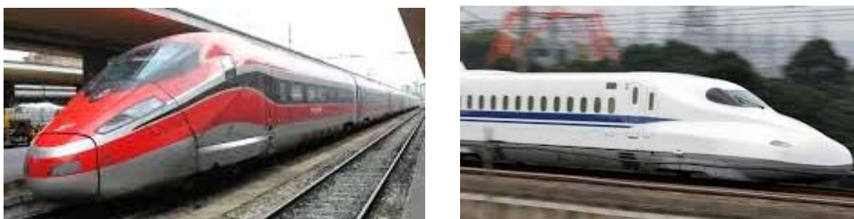
Figur 6.1 Italienska nya tåget ETR 1000 (till vänster) har aktiv sidofjädring och utprovas för höjd rälsförhöjningsbrist vid höga hastigheter. Japanska tåget N700 (höger) har både aktiv sidofjädring och en mindre korglutning.
