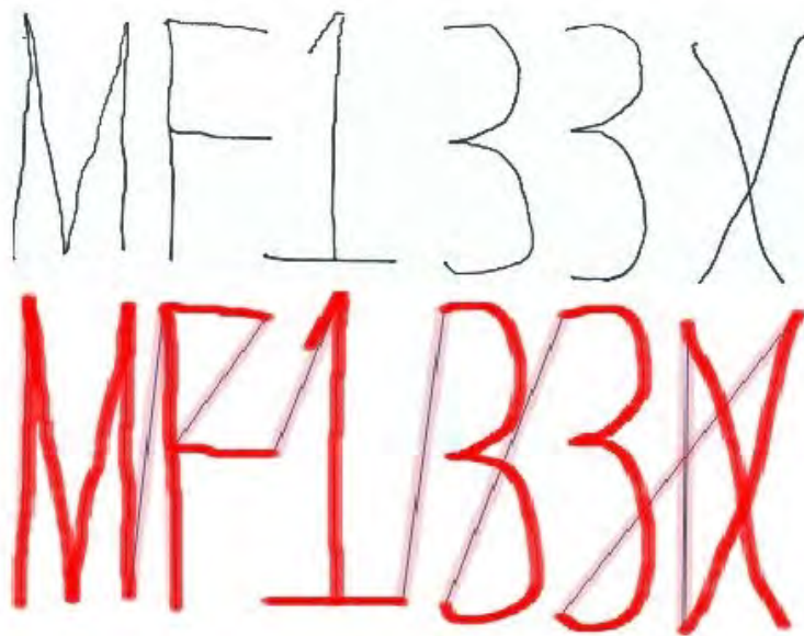
Figur 4.2. Texten MF133X ritad på ett helt A4 papper med roboten i svart färg. I röd färg är den bild som genererades i Matlab [14].
