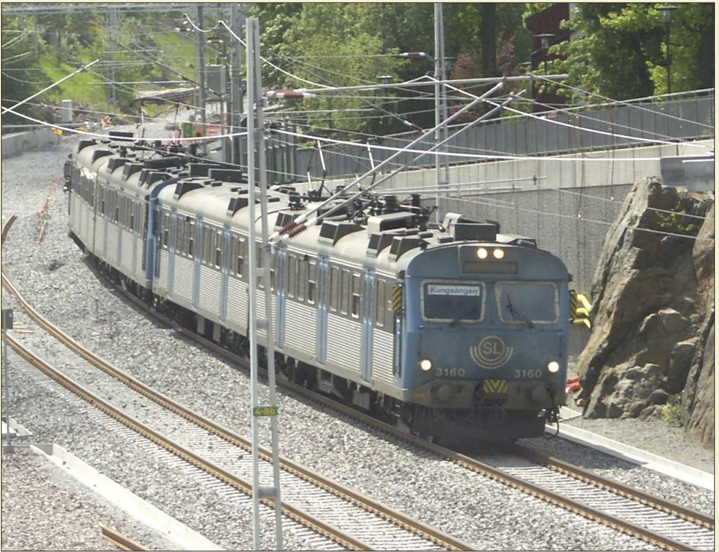
Den fordonstyp som använts som referens vid uppbyggnad av datormodellen är pendeltåget X10 med 10–15 tons axellast och 140 km/h som högsta hastighet.
