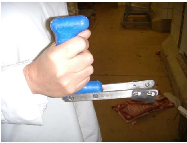
Figur 2. Ergonomiskt utformad manuell dragare för att sprita revben.
