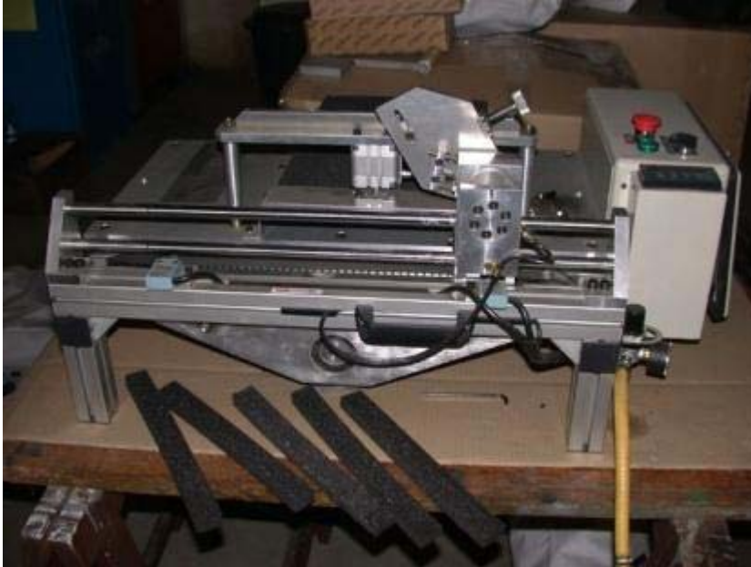
Figur 5. Maskin för test av knivskärpa (INRS/Dassaud)
