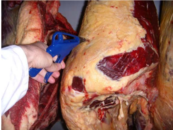
Figur 1. Blåsning av djurkropp med tryckluft enligt cleancut-systemet
