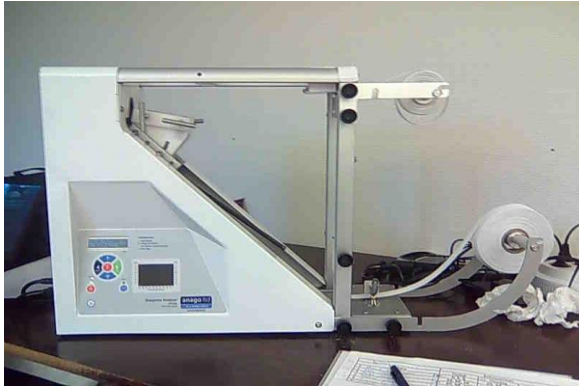
Figur 2. Mätapparat Anago för mätning av knivskärpa. (Eget foto).
