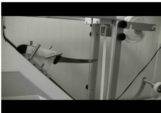
Figur 3. Kniven är monterad i mätapparat Anago och färdig att köras för mätning.
