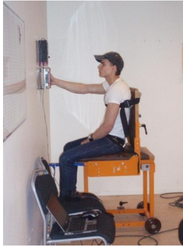
Figur 1: Illustration av hur försöken genomfördes. Under försöken tryckte den medverkande på det svarta handtaget med definierad kraft under en viss tid.
